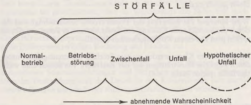
Fig. 1: Schematische Darstellung der möglichen Betriebszustände eines Kernkraftwerkes (gemäss KSA-Definitionen)
